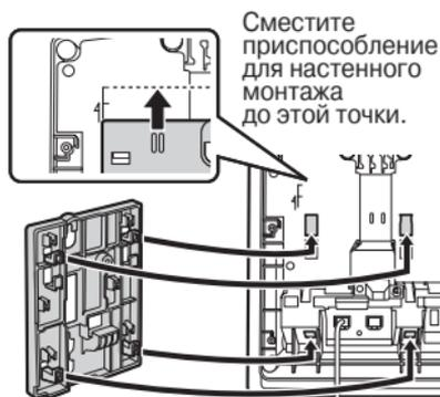
4. Заверните 2 винта (в комплекте поставки) в стену на расстоянии 83 или 100 мм друг от друга и установите аппарат на стене.
